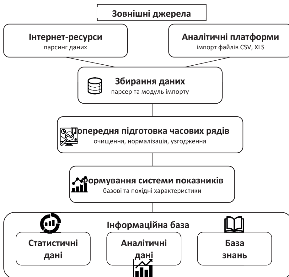
Рис. 2. Структурно-функціональна схема модуля збору та зберігання даних СППР
